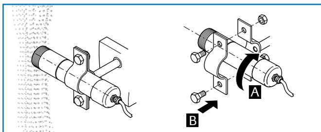
Montaje con bridas para cables
