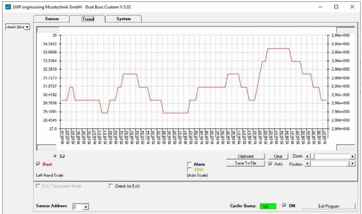
Podemos mostrar el valor de POLVO en el gráfico (casilla de verificación de polvo), el estado de la alarma (casilla de verificación de alarma) y el nivel de umbral (casilla de verificación TRH).
